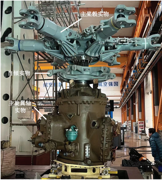
图 20 完成装配后的直升机升力系统
