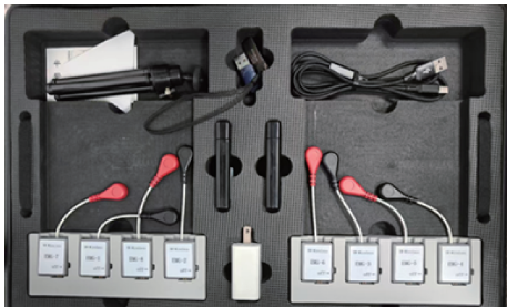
图 18 YW-Wireless 无线表面肌电测试系统 Fig. 18 YW Wireless surface electromyogram detection system
