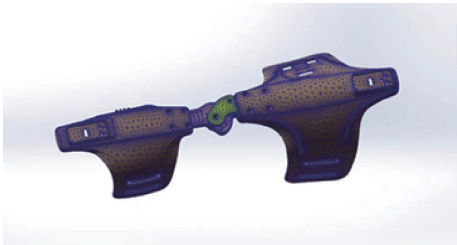
图 3 优化前腿部结构网格模型
