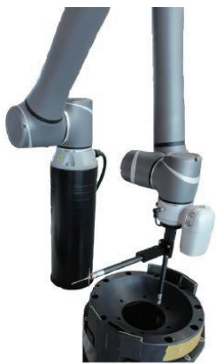
图 5 单点重复测量实验
