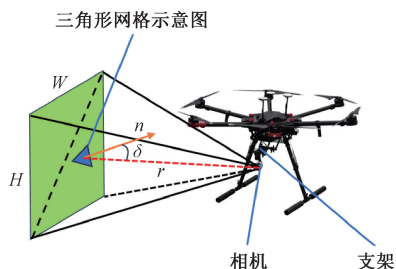
图2 观察点对于三角形网格的可见性示意图
