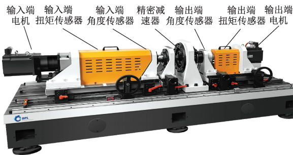
图4 双向传动性能测试台
