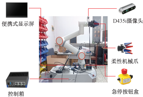
图 8 机械臂系统 Fig. 8 The robotic arm system
