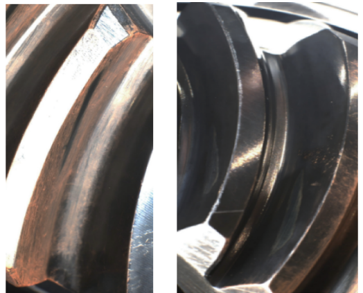
(a) 工业齿轮接触印痕: 原始彩色图像 (a) Industrial gear contact pattern: Original color image
