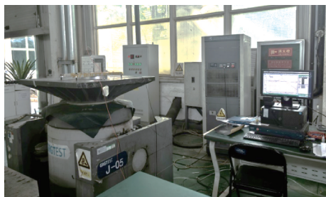
图 11 惯导隔振系统振动试验装置
