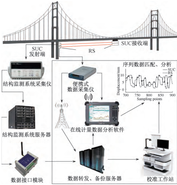
图 2 LDM 在线校准系统 Fig.2 Online calibration system of LDM
