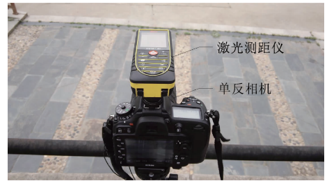
图 8 现场实验中的测量装置
