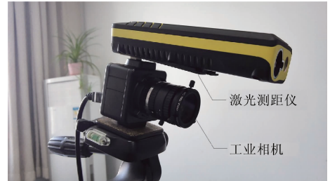
图6 室内实验中的测量装置
