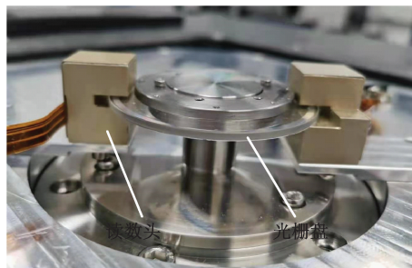
图 5 待测圆光栅测角系统
