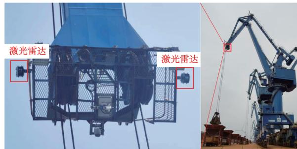
图1 门座式起重机钢丝绳束识别任务激光雷达安装
