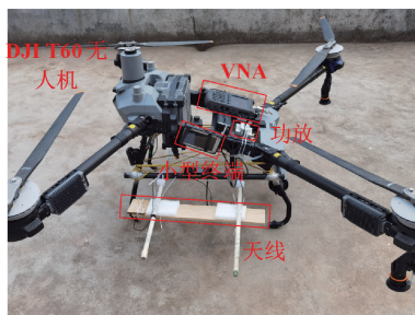
图 17 无人机载探地雷达原型系统
