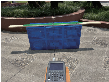
图 11 单极子天线 S_{21} 参数测试场景
