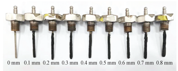
图 7 不同结垢厚度的均压电极样本
