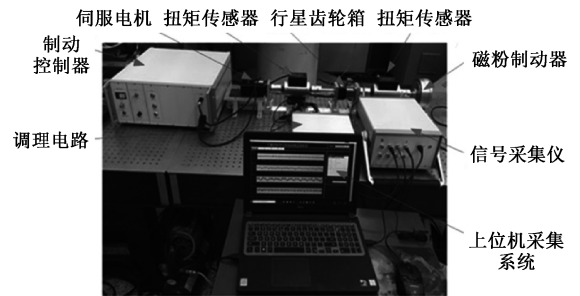
图 4 行星传动试验台
