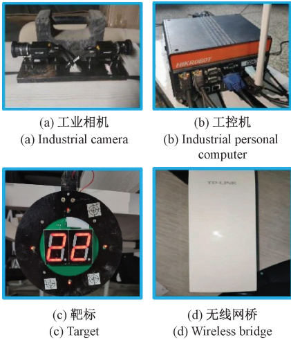
图 2 隧道围岩沉降监测系统仪器和设备
