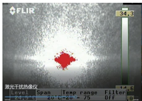
(a) 当薄膜处于半导体状态时,激光会对热成像仪器造成严重的干扰
