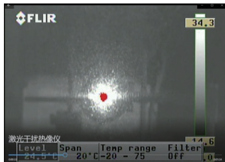
(b) 氧化钒薄膜处于金属状态时,对激光具有明显的保护效果
