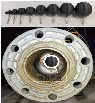
图 17 气泡模拟装置
