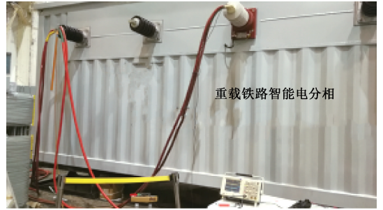
图 10 样机试验平台
