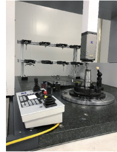
图 1 阶梯轴同轴度测量过程
