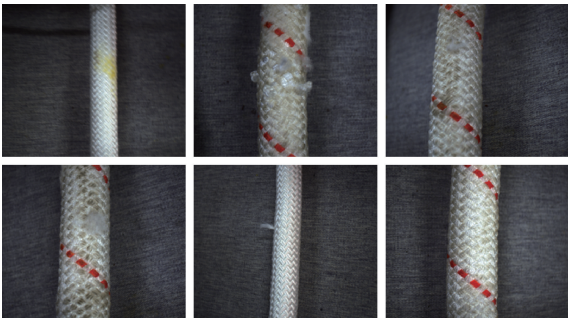
图 12 纤维绳索表面缺陷数据集
