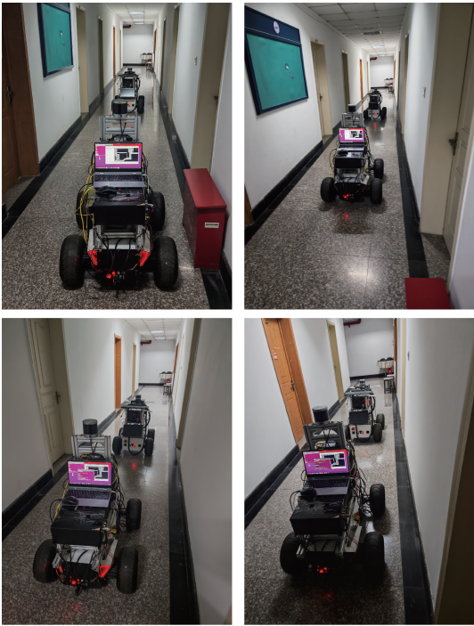
图 15 动态障碍物场景实际测试结果 Fig. 15 Actual test results in dynamic obstacle scenarios
