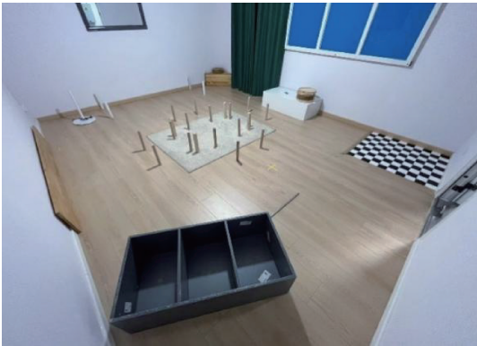
图 11 扫地机器人 IEC/ASTM 62885-7 标准场景 Fig. 11 Test bed configuration for IEC/ASTM 62885-7
