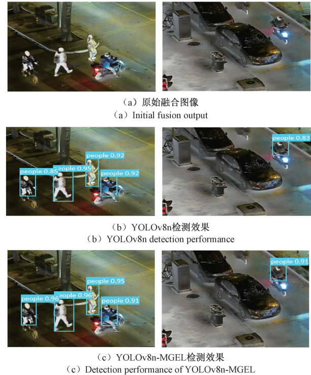
图 12 低光照条件下的检测结果对比 Fig. 12 Low-illumination detection benchmark
