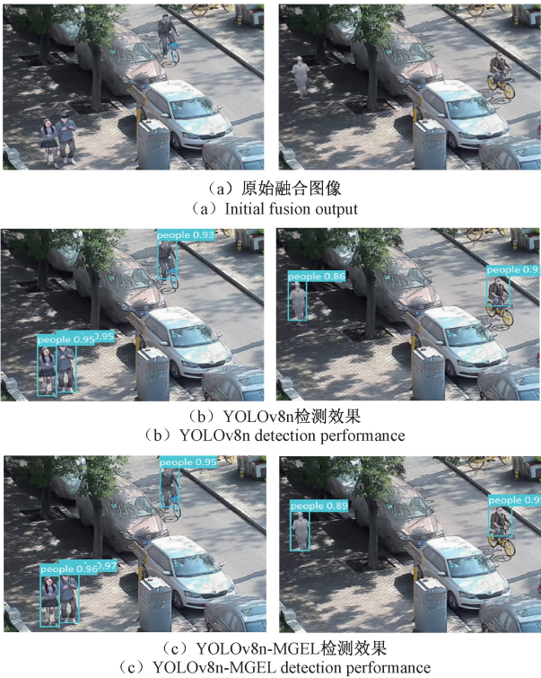
图 13 高光照条件下的检测结果对比 Fig. 13 High-illumination detection benchmark
