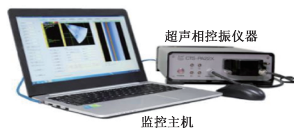
图 2 超声传感器与监控主机
