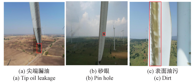
图 9 典型风机桨叶表面缺陷
