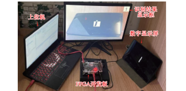
图 9 实机测试平台 Fig. 9 Real machine testing platform
