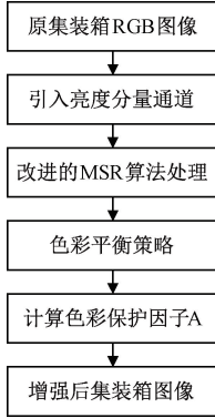
图1 引入亮度通道的改进 Retinex 算法流程
