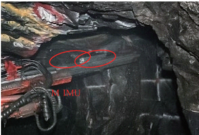
图 7 实钻井测量 Fig. 7 Actual drilling experiment MIMU
