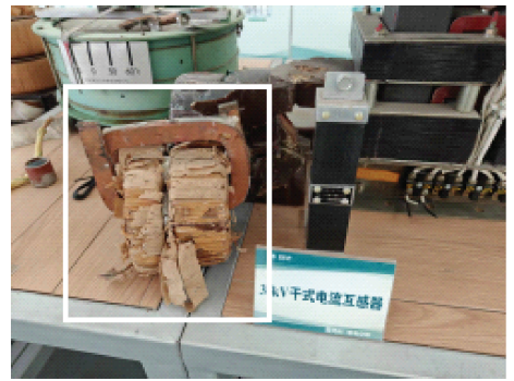
图 31 35 kV 干式电流互感器
