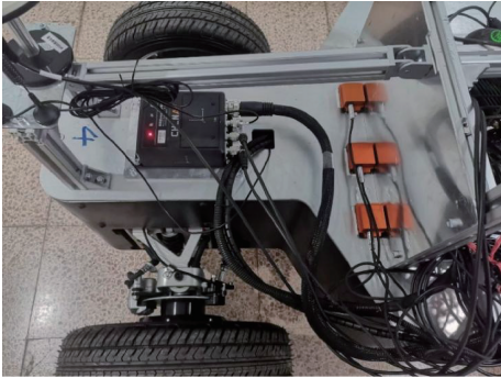
图 6 运动车载平台冗余 IMU 配置图
