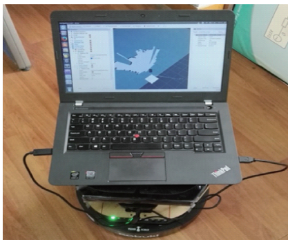
(c) 移动机器人正在创建栅格地图
