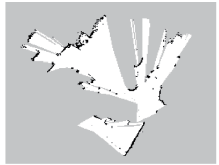
(a) 机器人A所创建栅格地图map_W
