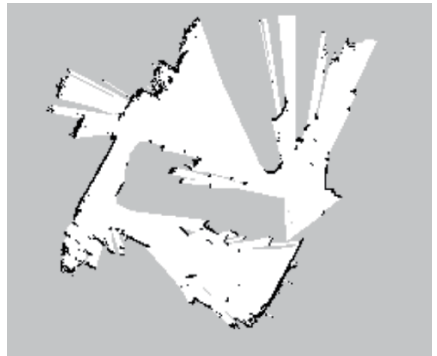
(c) 机器人栅格地图拼接结果
