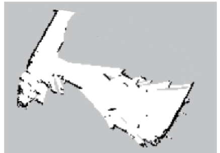
(b) 机器人B所创建栅格地图map_G
