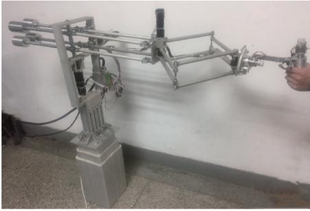
图2 手臂力觉反馈设备实物图
