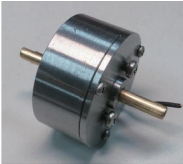
图 6 磁流变液阻尼器实物图
