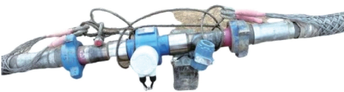
图 4 实验现场电磁流量计连接图 Fig. 4 Experimental site electromagnetic flowmeter connection diagram
