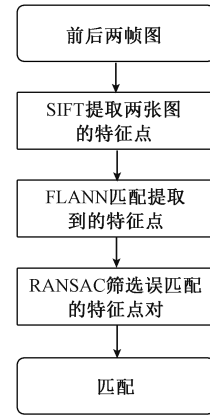
图 2 SIFT-FLANN-RANSAC 图像处理流程 Fig. 2 SIFT-FLANN-RANSAC image processing flow chart
