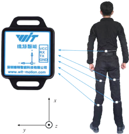
图3 IMU 测量单元放置人体部位示意图
