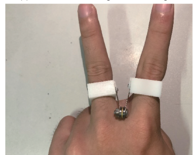
图 1 指间角度传感器模型及其穿戴示意图
