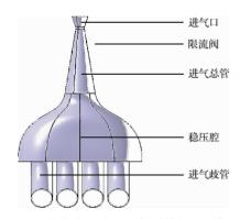
图 2 安装稳压腔的进气系统的 3D 模型
