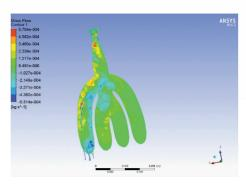
图 9 未安装稳压腔的进气系统 1 缸进气时的进气压力分析
