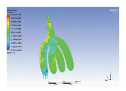
图 5 未安装稳压腔的进气系统 1 缸进气时的流量分析
