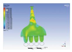
图 3 安装稳压腔的进气系统 1 缸进气时的气体流量分析
