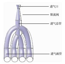
图 1 未安装带稳压腔的进气系统的 3D 模型
