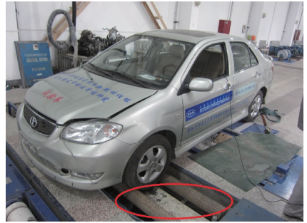
图3 无第三滚筒的反力式滚筒试验台
