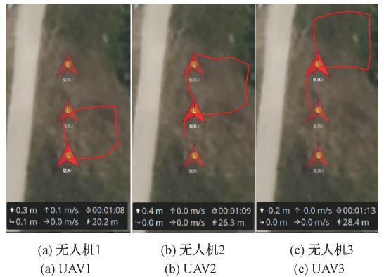
图 5 一字型编队无人机飞行轨迹图
