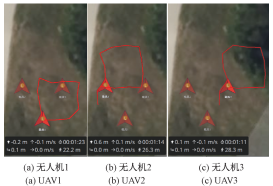
图 6 V 字型编队无人机飞行轨迹图
