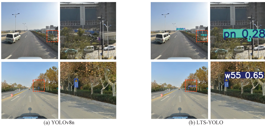
图 8 改进远距离小目标漏检问题
