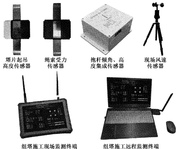
图 7 内悬浮抱杆输电铁塔组立监测系统
