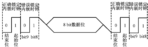
图7 指令码/同步码解码示意图
