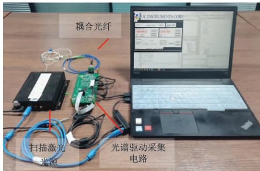
图12 传感器滤波性能测试实验系统
