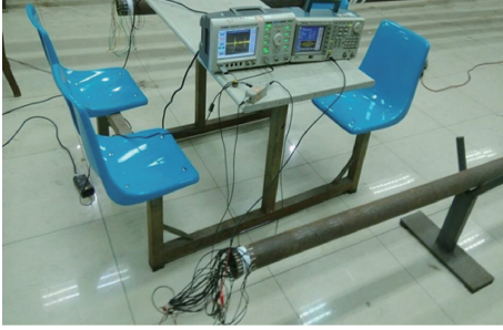
图 6 超声导波管道检测实验系统
