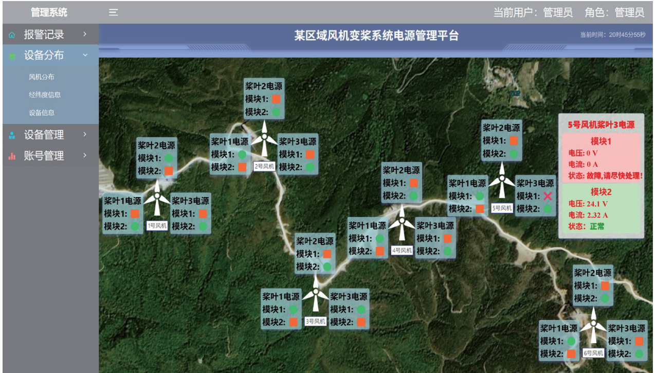
图 19 风机变桨系统电源监控平台
