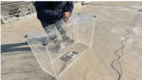
图 14 模拟扬尘试验
